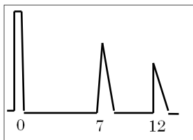
図4 深さが7mmと12mmのエコー(垂直探傷図形)
